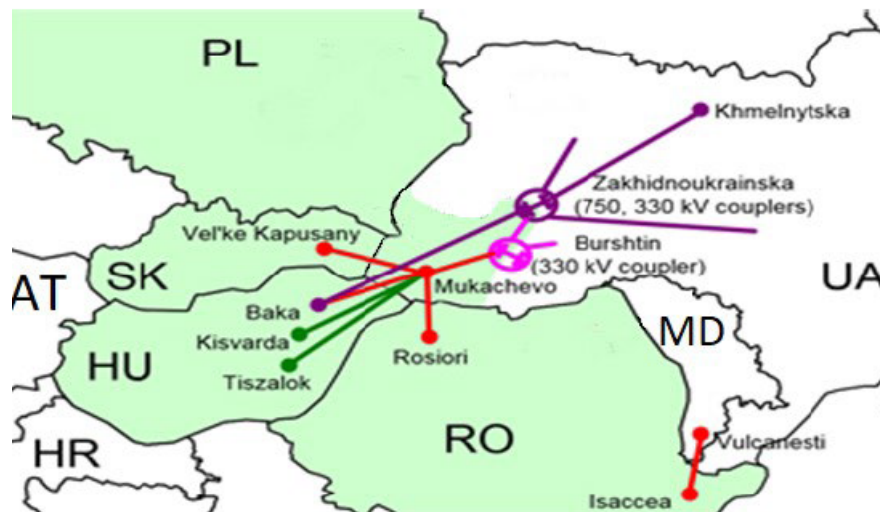
3.ábra: A szinkron csatlakozás hálózatának főbb távvezetékei forrás: MAVIR Zrt.
