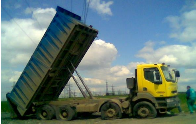
3. ábra: Munkagép által okozott rövidzár
