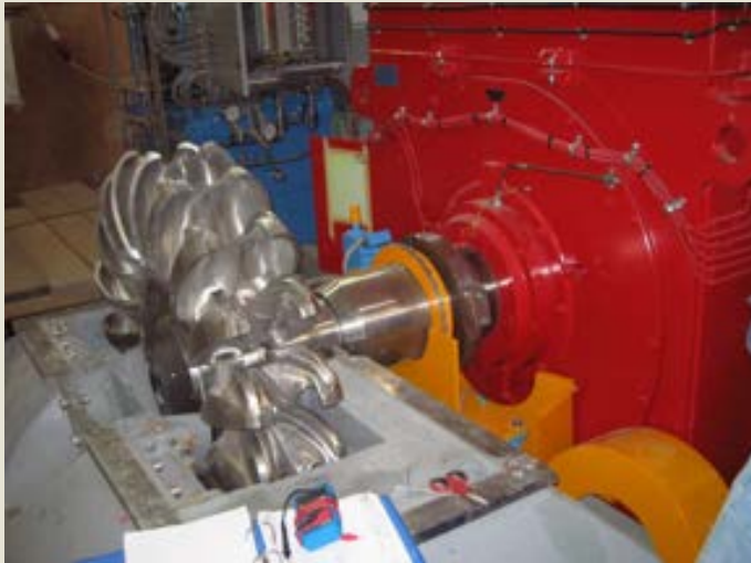
Ganz 2011 SRGb636Hw6 Cogno (Olaszország), Pelton 13tonna / 2,4MVA = 5,41tonna/MVA 1000ford/perc, azaz 6 pólus
